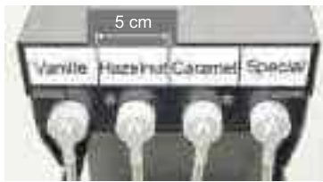
図: シロップボトルとシロップポンプの間のホース接続部のラベル
